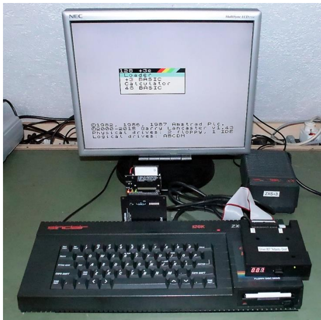
Spectrum+3 aufgestecktem mit 8-Bit-IDE und Gotek-Laufwerk
